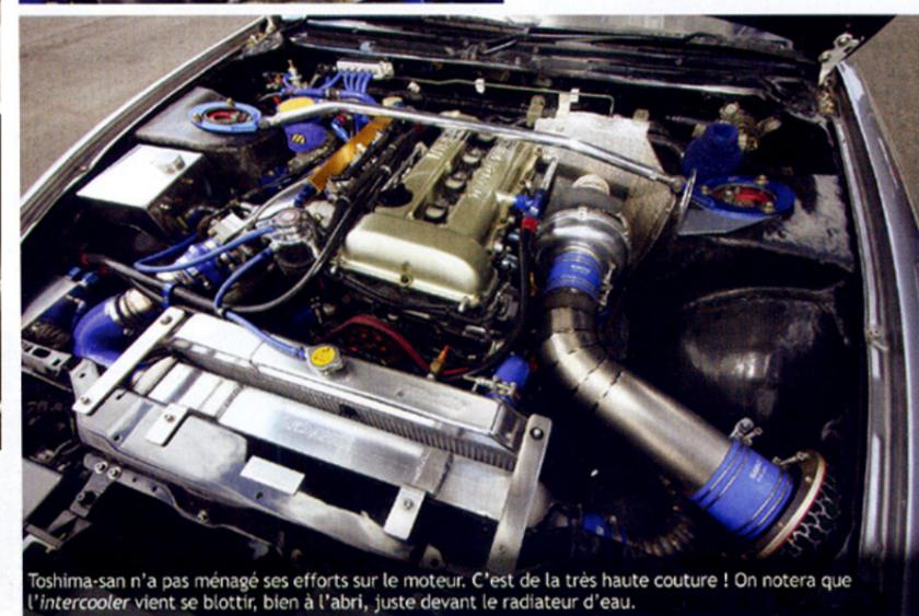
Toshima-san n'a pas ménagé ses efforts sur le moteur. C'est de la très haute couture ! On notera que l'*intercooler* vient se blottir, bien à l'abri, juste devant le radiateur d'eau.
